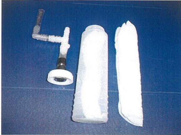
この気管内投与用肺モデルは通常の肺のジョイント部分を外し、水分を吸収する素材を中に入れたボトルを装着することにより、通常の人工呼吸などの換気を実施しながら、気管内投与を実施することも可能である。
