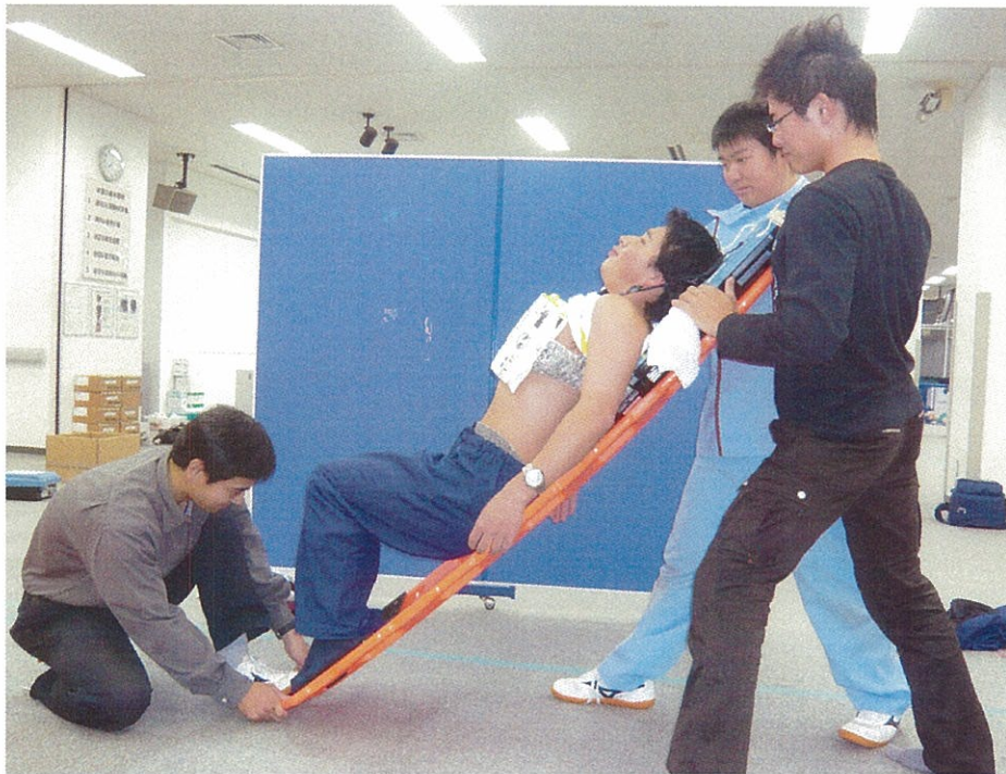
図 9 AutoPulse を装着した状態で角度をつけて圧迫部位のずれを計測
