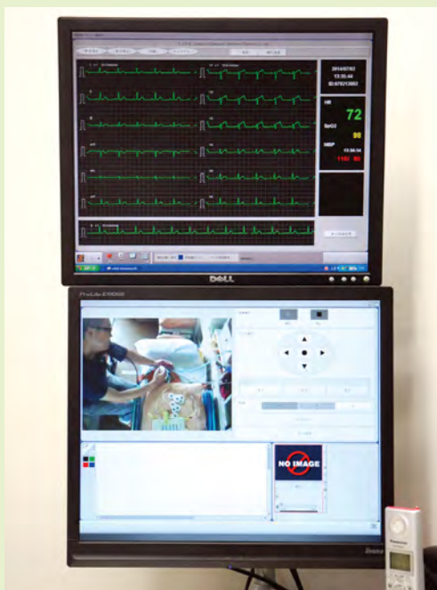
▲病院に設置されたディスプレイ。上に12誘導心電図・心拍・SpO 2 ・血圧が、下に車内を映した映像がリアルタイムで表示される。
