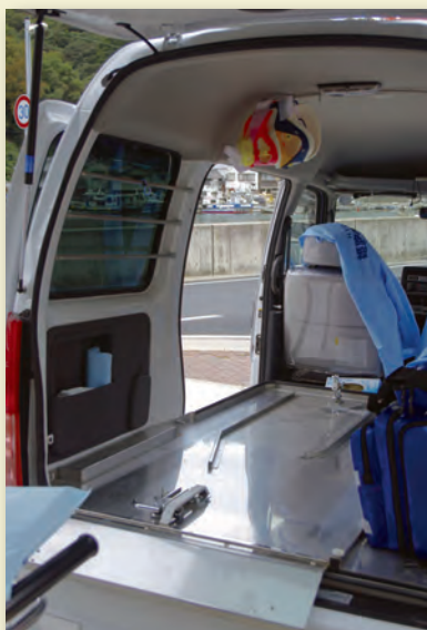
▲ストレッチャー固定の台は衛生面を重視したステンレス切り出し
